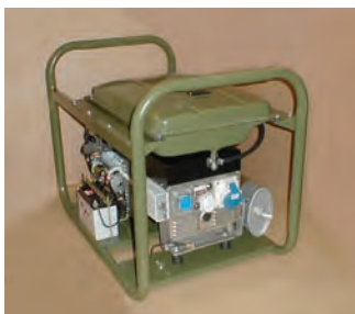
Электроагрегат 10 кВт, бензин, военного исполнения
