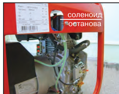
Защитное отключение при минимальном давлении масла
