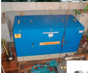
Два главных двигателя плюс АДС 14 - Т230 ТЯ в машинном отделении теплохода.
