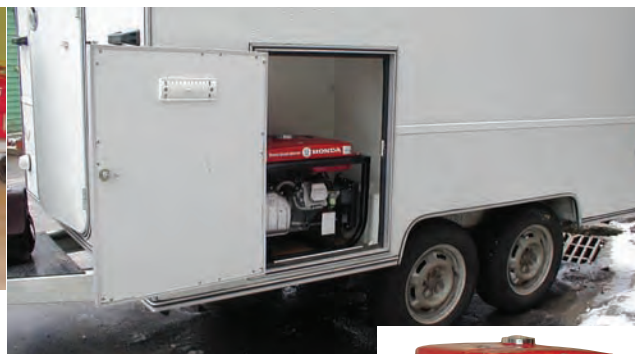
АБП 2,7-230 ВХБГ серийно устанавливается в прицеп "Тонар"
