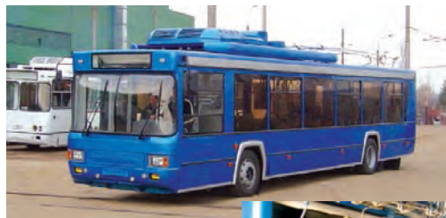
Первый в России троллейбус Башкирского троллейбусного завода с возможностью автономного движения без внешней электрической сети
