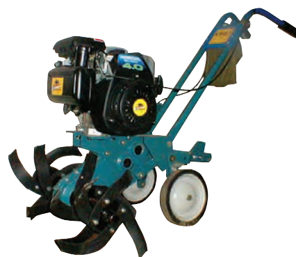
Мотокультиватор типа “Крот” с карбюраторным двигателем Honda.
